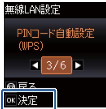
3. プリンターに表示されているPINコード (8桁の数字) を、2分以内にコンピューターからアクセスポイントに入力します。
