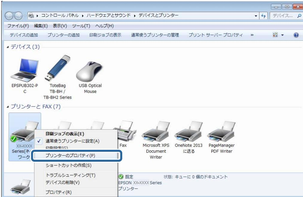
3. 【ポート】タブを選択して、選択されている印刷ポートを確認します。
