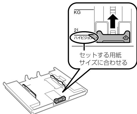
5. 印刷する面を下にして、手前の用紙ガイドに合わせてセットします。
