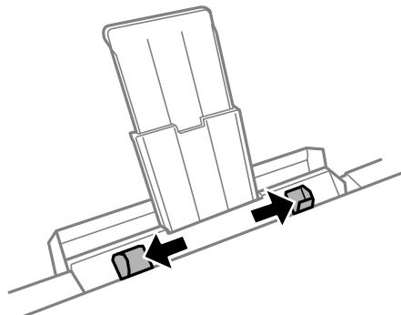
6. 印刷する面を手前にして、用紙の先端を約5cm差し込みます。正しくセットされると「ピッ」と音がします。
