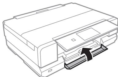
5. プリンターの底面に収納されているディスクトレイを取り出します。
