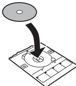
7. ディスクトレイをプリンターに挿入します。プリンター側とトレイ側のマークを合わせてください。
