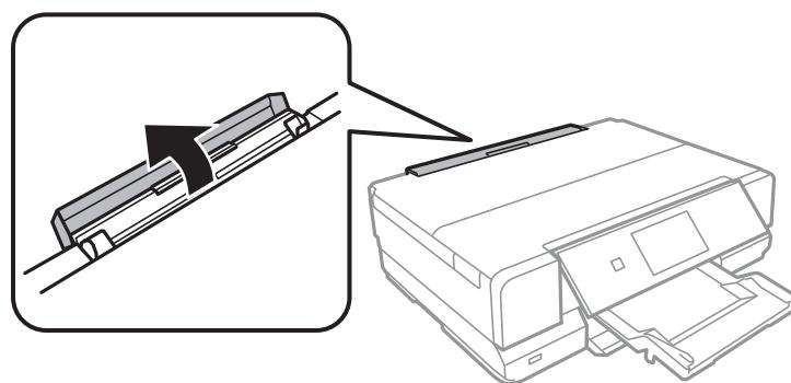
4. 用紙サポートを引き出し、後ろに倒して固定します。
