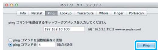
10 通信しているときは、送信した信号がすべて返信されるため、図 1 のように [0.0% packet loss] が表示されます。通信していないときは、送信した信号がすべて返信されないため、図 2 のように [100.0% packet loss] が表示されます。通信していないときは、各機器のネットワーク設定を確認してください。
