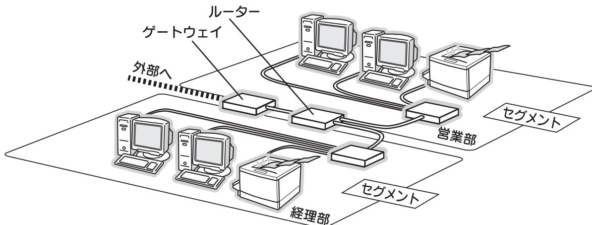
エリアを示す仕組みに利用されるのが、サブネットマスクです。サブネットマスクは、IP アドレスと同様、数字の羅列（例（IPv4）：255.255.255.0）で表されます。
