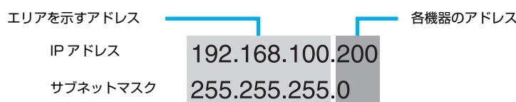
プリンターを利用するコンピューターは、IP アドレス・サブネットマスク・ゲートウェイアドレスなどを設定する必要があります。下表を参考に設定してください。
