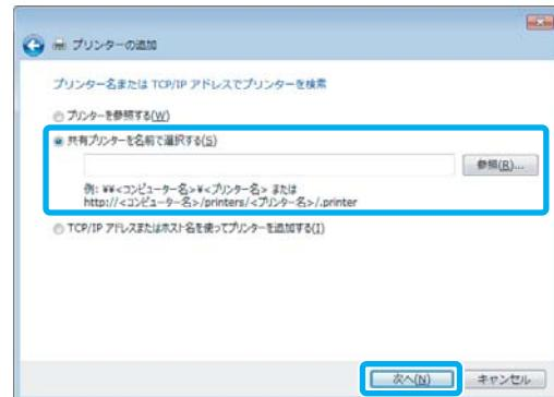
**6 共有プリンターを設定したプリントサーバーをダブルクリックまたはクリックし、共有プリンターの名前をクリックして[選択](または[次へ])をクリックします。**
