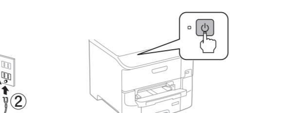
電源ランプが点滅しないときは電源コードの接続を確認してから【電源】ボタンを長めに押して、電源を入れ直してください。
