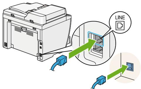
電話線は 4 芯のものを使用してください。プリンター付属の電話線は 4 芯です。接続先の電話線差込口も 4 芯対応であることを推奨します。
