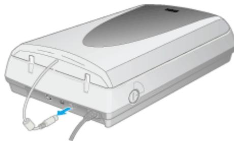
**5. 本体側面にある固定ノブと原稿カバーの内側にある固定レバーをの 位置にして、キャリッジを固定します。**
