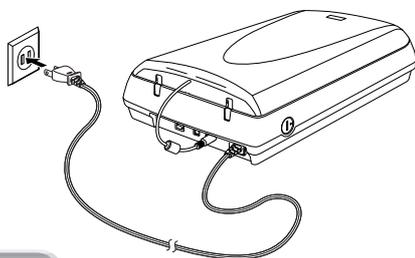
コンセントの電圧が100Vであることを確認して、電源プラグをコンセントに差し込みます。
