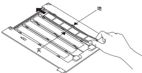
カバーを外してストリップフィルムをセットします。
