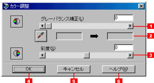
プレビューウィンドウに表示している画像で効果を確認しながら、色を調整できます。現在、選択されている取り込み枠に対して有効です。
