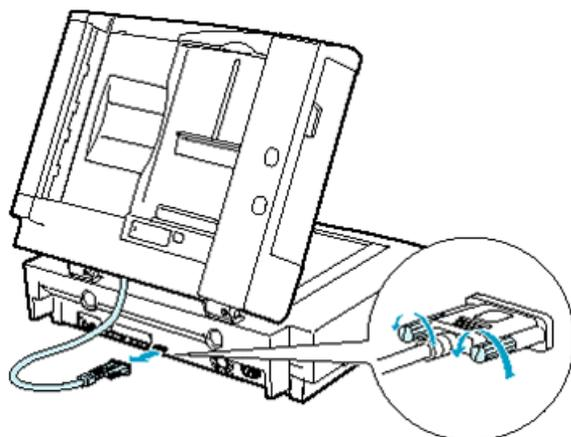
2. ADFを開けます。ADFを手で支えながら、ADFを固定しているナットを外し、ADFをゆっくり取り外します。
