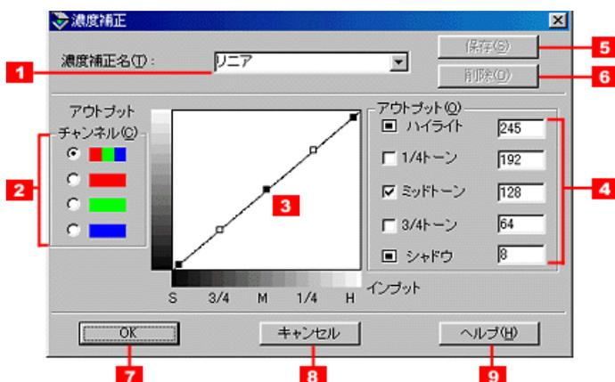
濃度はトーンともいいます。スキャナで取り込んだ画像の濃度データを、トーン曲線に合わせて補正し、出力データとする機能です。シャドウ、ミッドトーン（中間調）、ハイライトへと変化していく濃度の曲線を補正することで、画像全体の濃度をバランス良く上げることができます。現在、選択されている取り込み枠に対して有効です。
