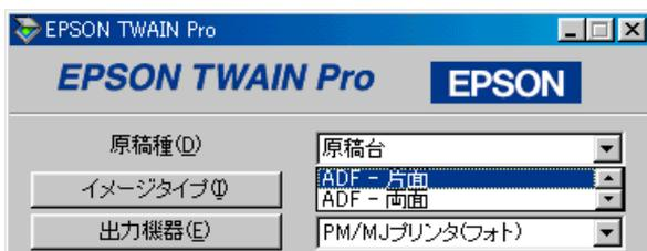
なお、この項目で [ 原稿台 ] を選択すれば、ADF を取り付けたままでも、原稿台にセットした原稿を取り込むことができます。カラー原稿、中間調原稿を高品位で取り込みたい時は、ADF を使わず、原稿台から取り込むことをお勧めします。
