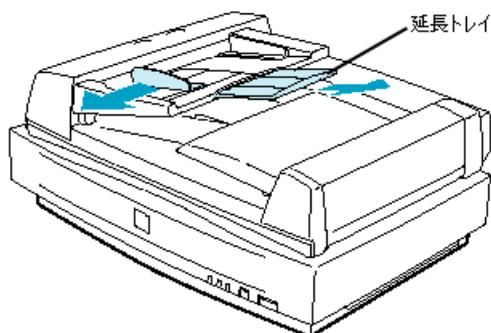
2. 原稿の取り込む面を上にして、ADFの目盛りに合わせて奥に突き当たるまで差し込みます。
