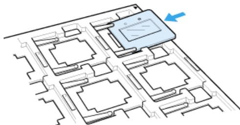
2. 透過原稿ユニットを開けます。フィルムのベース面が下になるように、スライドフィルムを原稿台にセットします。
