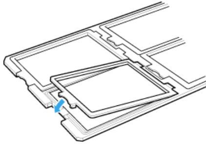
2. 透過原稿ユニットを開けます。フィルムのベース面が下になるように、フィルムホルダを原稿台にセットします。
