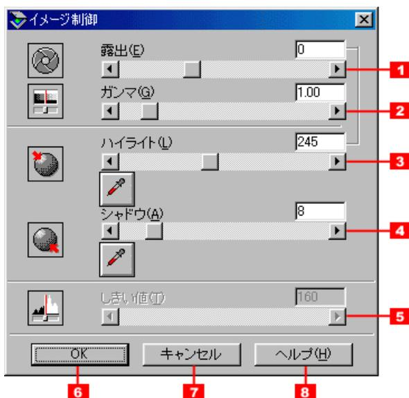
プレビューウィンドウに表示している画像で効果を確認しながら、ハイライトやシャドウなど、取り込む画像の明暗を調整できます。現在、選択されている取り込み枠に対して有効です。ここでの調整によって、原稿のハイライトレベル/シャドウレベルを適切な範囲に納めることができます。
