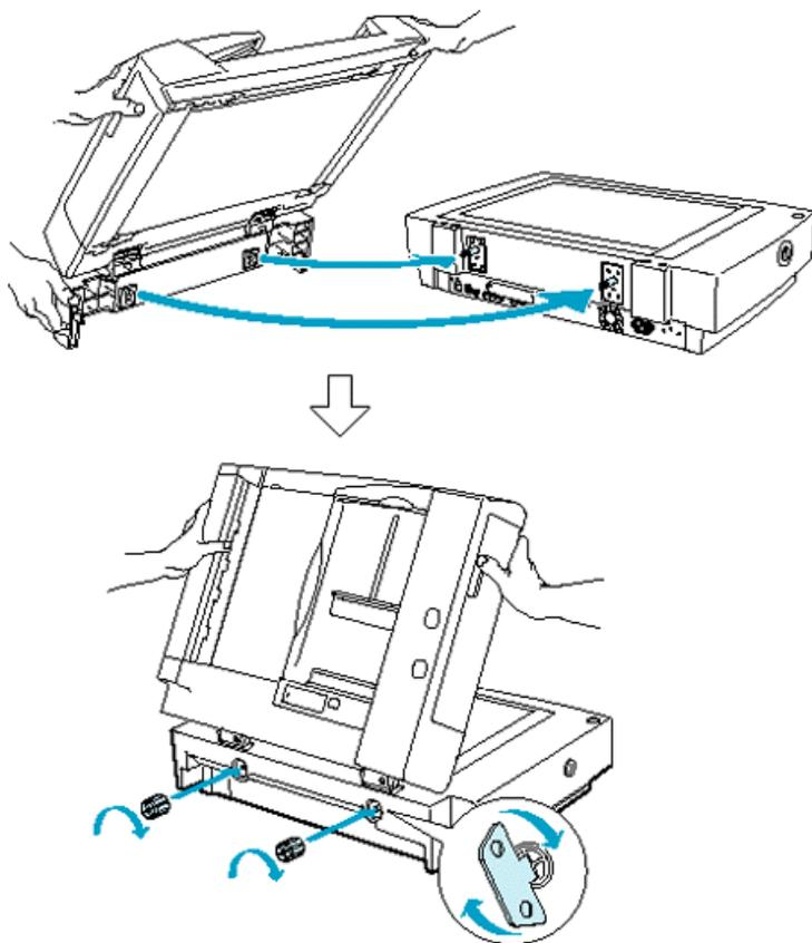
8. スキャナ背面のオプションコネクタに ADF のコネクタを取り付け、コネクタ両脇のネジで固定します。
