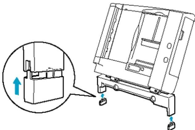
7. ADF を 2 人以上で持ち上げます。スキャナ背面に取り付けたネジに ADF の取り付け穴を差し込み、ナットで固定します。
