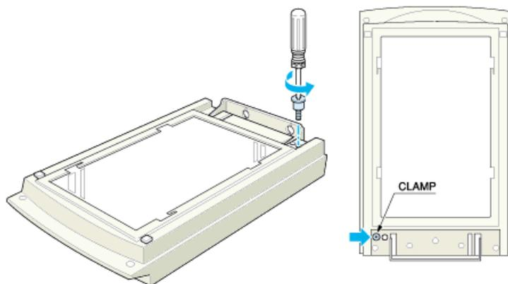
3. 取り外したネジを、図の位置の保管（STOCK）穴に取り付けます。
