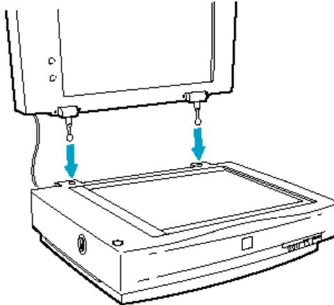
4. 透過原稿ユニットを閉じます。スキャナ背面のオプションコネクタに透過原稿ユニットのコネクタを取り付け、コネクタ両脇のネジで固定します。
