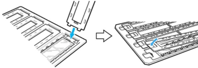
2. 透過原稿ユニットを開けます。フィルムのベース面が下になるように、フィルムホルダを原稿台にセットします。
