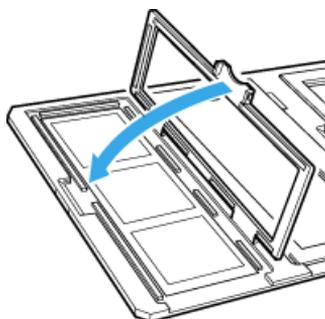
2. 透過原稿ユニットを開けます。フィルムのベース面が下になるように、フィルムホルダを原稿台にセットします。
