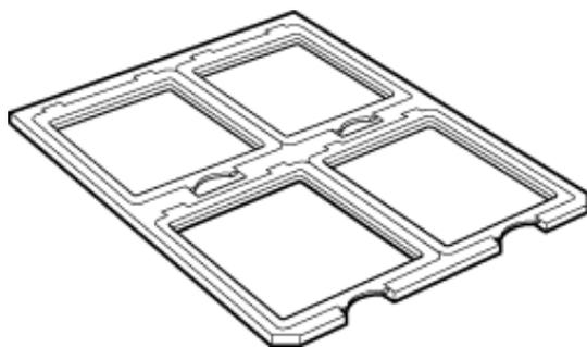
1. 4 × 5 インチフィルムホルダに、4 × 5 インチフィルムをセットします。
