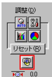
ボタンを押すたびに、0mm（ガラス面にピントが合う位置）と 2.5mm（フィルムホルダにセットしたフィルムにピントが合う位置）が切り替わります。
