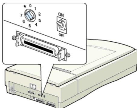
2. スキャナの電源をオンにします。キャリッジがロック位置に移動しますので、輸送用固定レバーを LOCK にしてキャリッジを固定します。
