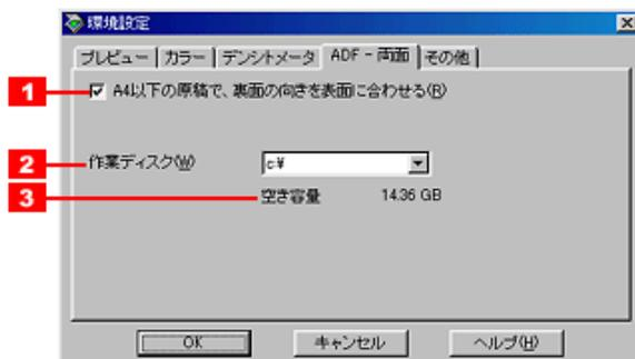
この画面の設定は、A3 スキャナにオプションのオートドキュメントフィーダ (ESA3ADF2) を装着して、A4 以下の原稿の両面 (表面と裏面) を取り込む場合に有効です。ESA3ADF2 から原稿の両面を取り込む場合、原稿をセットする向きによっては、裏面が 180° 回転した状態で取り込まれます。この画面の設定を有効にすると、180° 回転して取り込まれた裏面の画像を、正しい向きに回転します。
