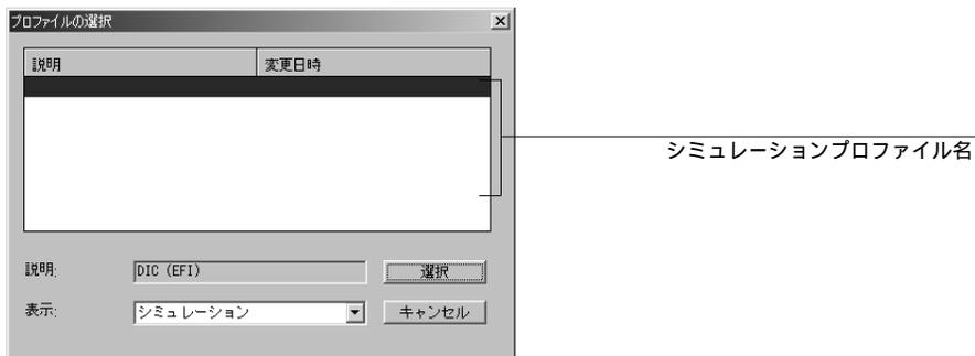
「シミュレーション」では Fiery Spark Pro 内蔵のシミュレーションプロファイルが、「出力」では Fiery Spark Pro 内蔵の出力プロファイルが表示されます。
