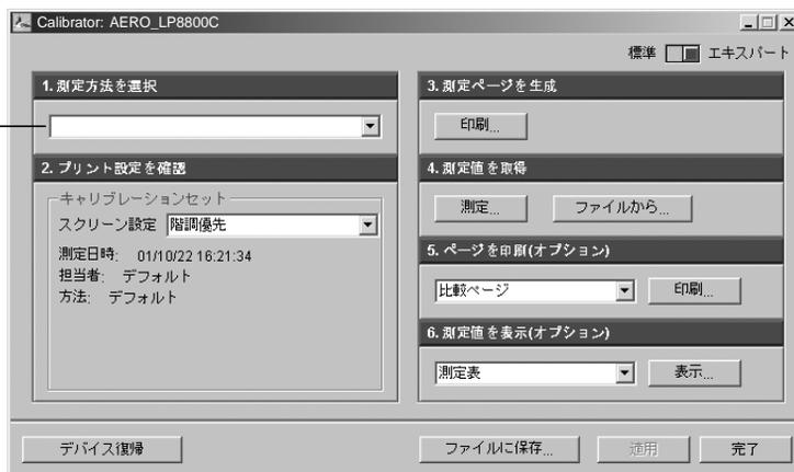
「ページを印刷 (オプション)」では、新測定値と既存のキャリブレーションセットを使用したキャリブレーションを検証するために、比較ページを印刷できます。
