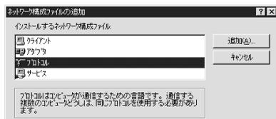
[ネットワークプロトコルの選択]画面が表示されます。製造元：Microsoft、ネットワークプロトコル：TCP/IP をクリックして追加します。
