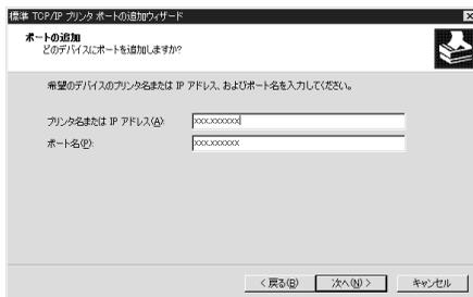
何らかの理由でプリンタが正しく検出されなかった場合は、右の画面が表示されます。この画面が表示されたら、[標準]を選択し、[EPSON Network Printer]を選択します。あとはメッセージに従ってプリンタドライバをインストールしてください。
