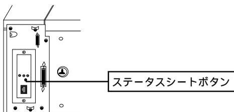
I/Fカードの緑と赤のランプが点滅し始めたら、ボタンから指を離します（初期化作業中であることを表します）。ランプの点滅が終わったら初期化は完了です。
