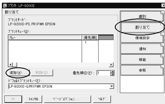
プリントキューの一覧が表示されるので、手順4で作成したキューを選択し、**OK** ボタンをクリックします。
