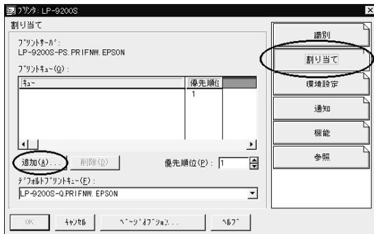
プリントキューの一覧が表示されますので、割り当てるキュー（手順2で作成したキュー）を選択し、**OK** ボタンをクリックします。
