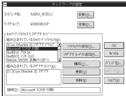
[Microsoft TCP/IP 印刷]がない場合は、[ソフトウェアの追加] ボタンをクリックして[TCP/IP プロトコルおよび関連コンポーネント]を選択します。
