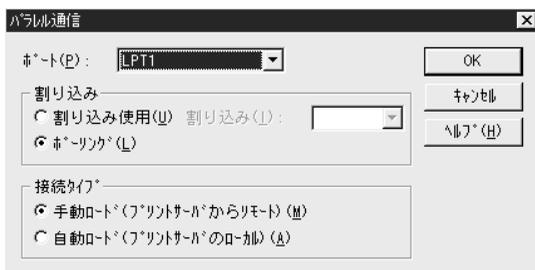
設定が終了したら **OK** ボタンをクリックして[平行列通信]画面を閉じ、[プリンタ]画面で **OK** ボタンをクリックします。
