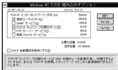
インストールが終了して、[ネットワークの設定]画面で **OK** ボタンをクリックすると、[TCP/IP の構成]画面が開き IP アドレスなどの必要事項を設定できます。設定する IP アドレスについては「困ったときは」(205 ページ)を参照してください。
