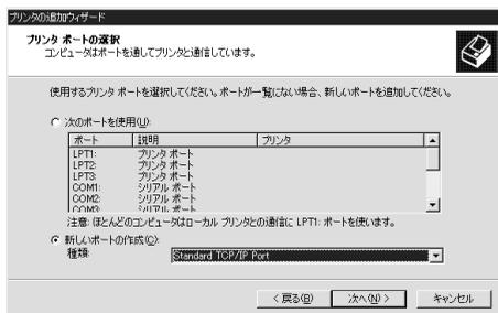
[標準TCP/IPプリンタポートの追加ウィザード]が表示されたら、**次へ** ボタンをクリックします。
