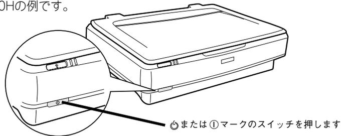
スキャナの電源をオンにすると、ESNSB2の電源も連動してオンになり、ESNSB2のランプの状態が次のように変わっていきます。Readyランプの点滅が点灯が変わったら、準備完了です。
