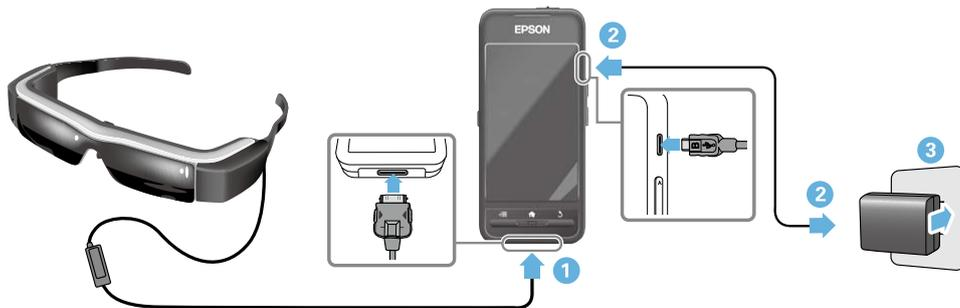
LED インジケーターの点滅が終了し、青緑色に点灯したら充電完了です。AC アダプターと USB ケーブルを取り外してください。
