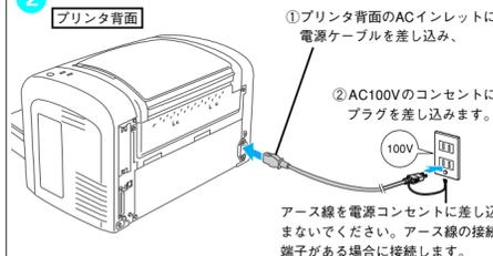
③ アース線を電源コンセントに差し込まないでください。アース線の接続端子がある場合に接続します。
