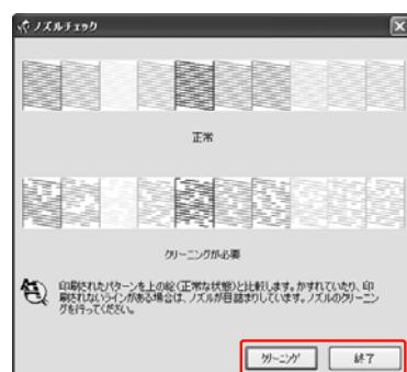
ノズルチェックパターン印刷直後に、印刷またはクリーニングするときは、ノズルチェックパターン印刷が完全に終了していることを確認してから実行してください。
