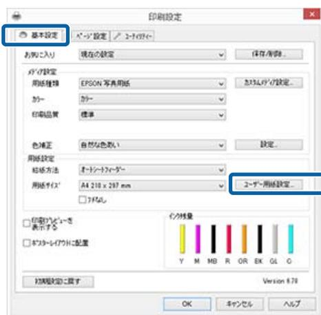
**2** [ユーザー定義用紙サイズ] 画面で、使用する用紙サイズを設定し、[保存] をクリックします。
