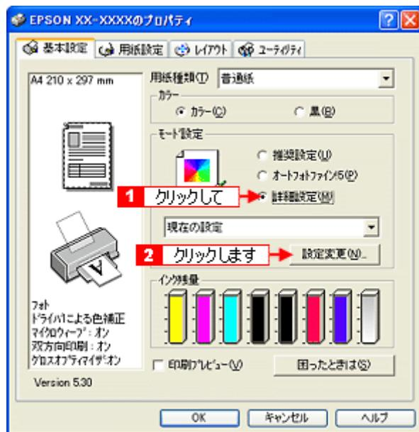
3. [ドライバによる色補正] をクリックして、以下に説明する 1 から 5 の各項目を設定します。
