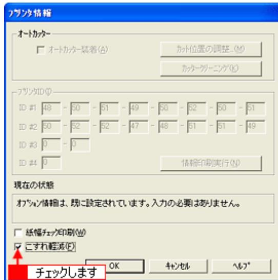
それでも汚れが発生する場合は、アプリケーションソフトで上下の余白を広くして、印刷データを印刷推奨領域内に配置し直してから印刷してください。
