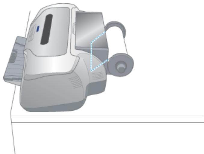
**5. ロール紙挿入口に、フォトアルバム紙を挿入します。**
