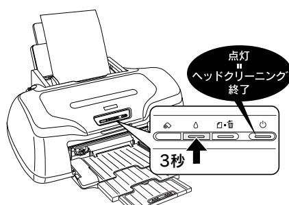
2 ヘッドクリーニング後は、再度ノズルチェックを行って、ノズルの目詰まりが解消されたかどうかをご確認ください。
