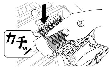
プリンタ本体のラベルの色とインクカートリッジのラベルの色を合わせてセットします。
