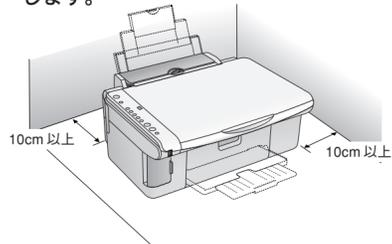
作業しやすいように十分なスペースを確保して設置してください。本製品前面には排紙トレイを引き出せるだけのスペースが必要です。また、壁際に設置する場合は、壁から 10cm 以上のすき間をあけてください。
