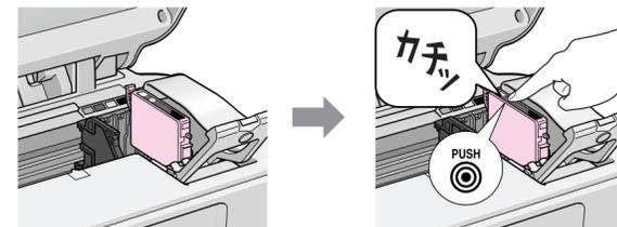
**注意** インクカートリッジは、まっすぐ挿入してください。インクカートリッジは、ラベルの色を合わせないと正しくセットできません。インクカートリッジがうまく入らない場合は、ラベルの色をご確認ください。4 色すべてのインクカートリッジをセットしてください。セットされていないインクカートリッジがあると、本製品は使用できません。
