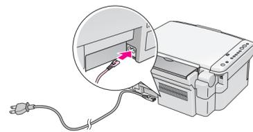
**注意** 添付されている電源コード以外の電源コードは使用しないでください。添付されている電源コードをほかの機器で使用しないでください。
