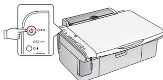
**注意** 電源のオン/オフは、電源プラグの抜き差しで行わずに、必ず本体の電源ボタンで行ってください。電源ボタンでオン/オフしないと、正常に印刷できなくなるおそれがあります。パソコンとつないでお使いになる場合でも、まだ USB ケーブルは接続しないでください。
