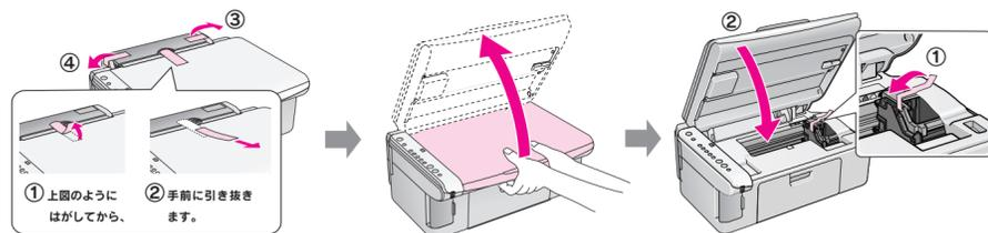
用紙サポート部に貼付されているテープを上記の手順で取り外します。 スキャナユニットを開きます。 本体内部のテープを取り外してから、スキャナユニットを閉じます。
