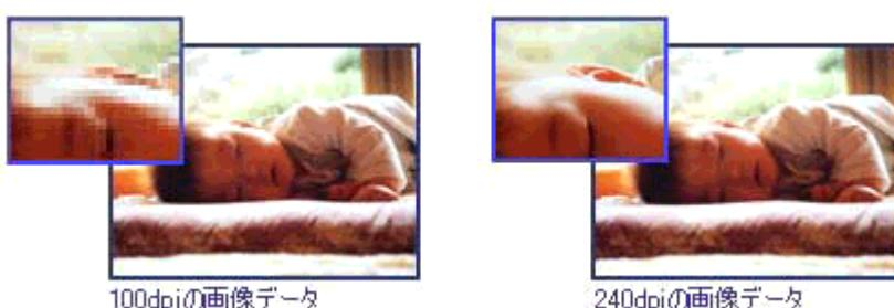
本プリンタの特長の 1 つである 2880dpi 印刷とは、25.4mm (1 インチ) の長さ当りに 2880 個のインクの点を並べて打つことにより画像を構成していることを意味します。
