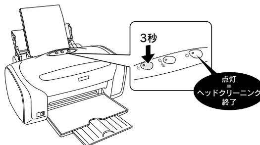
2 ヘッドクリーニング後は、再度ノズルチェックを行って、ノズルの目詰まりが解消されたかをご確認ください。
