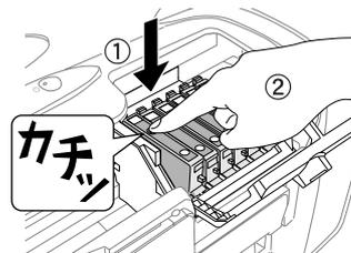
プリンタ本体のラベルとインクカートリッジのラベルの色を合わせてセットします。
