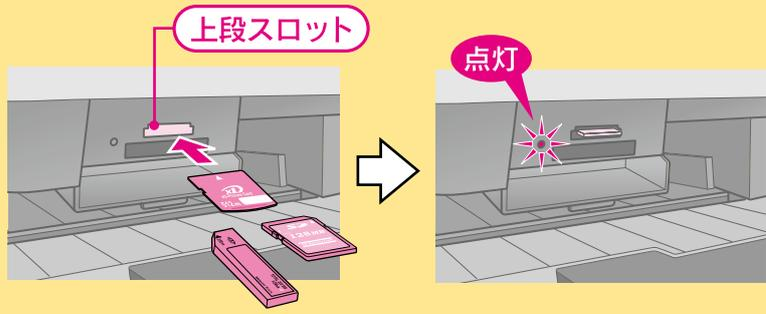
\*1: 各カードの専用アダプタにカードを差し込んでから、本製品のスロットに差し込んでください。
