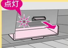
印刷が終了したらメモ리카ードスロットカバーを開けて、メモ리카ードを取り出してください。
