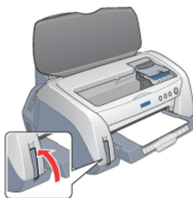
**11. プリンタカバーを閉じて、[用紙] スイッチを押します。**
