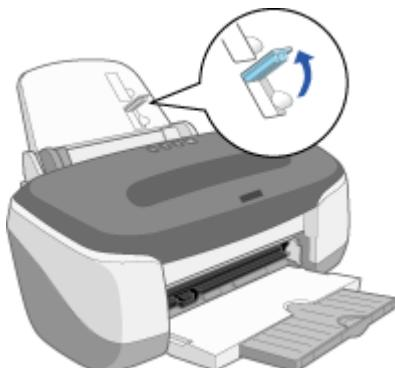
4. 印刷する面を手前側にして、ハガキをオートシートフィーダの右側に沿わせて縦方向にセットします。続いてエッジガイドをハガキの側面に合わせます。
