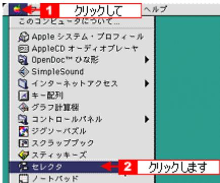
2. 本プリンタのアイコンをクリックして、[ ポートを選択 ] の一覧に表示されている共有設定をしたプリンタ (PM-XXXX) をクリックして選択します。
