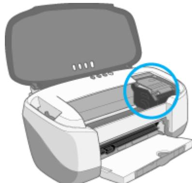
ここで、プリントヘッドを正しくキャッピングするために注意していただきたいことがあります。正しくキャッピングするためには、電源のオン / オフを電源スイッチで行ってください。プリンタの電源スイッチで電源をオフにすることで、しっかりとキャッピングされてから電源が切れます。もし、電源プラグを抜いて電源を切ったりすると、正しくキャッピングされずに電源が切れて、プリントヘッドが乾燥してしまうおそれがあります。また、電源プラグをコンピュータ背面のサービスコンセントや、スイッチ付きテーブルタップに接続した場合も、キャッピングされていない状態で電源が切れてしまうおそれがあります。こういったことを回避するためにも、電源プラグは壁などに直付けされているコンセントに差し込み、電源のオン / オフは電源スイッチで行うようにしてください。
