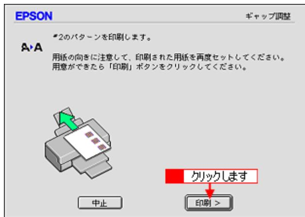
13. 画面の指示に従い、印刷された用紙をもう一度同じ向きにプリンタにセットします。
