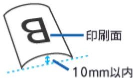
また、片面に印刷後、その裏面に印刷するときは、しばらく乾かした後、反りを付け直してください。
