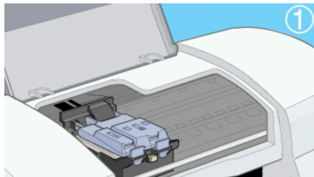
6. インクカートリッジの EPSON マークを固定カバー側に向け、固定カバーのツメの上にインクカートリッジのツメを載せるようにして置きます。
