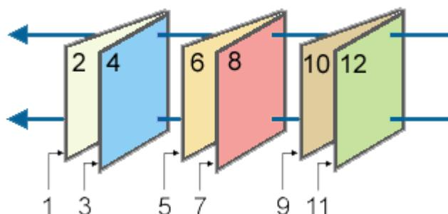
5. 奇数ページの印刷が終了すると【案内】画面が表示されます。画面の表示に従って用紙の裏面を上に向けて、オートシートフィーダにセットし直します。
