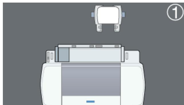
8. ロール紙をオートシートフィーダの右側に沿わせて給紙口に突き当たるまで差し込み、エッジガイドをロール紙の側面に合わせます。
