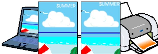
フチなし全面印刷（四辺フチなし印刷）時は、裁ち落とし印刷（用紙より少しあみ出した印刷）をするために、写真を用紙サイズよりも少し拡大処理します。（最大で上 3mm/ 左右 2.5mm/ 下 5mm）
