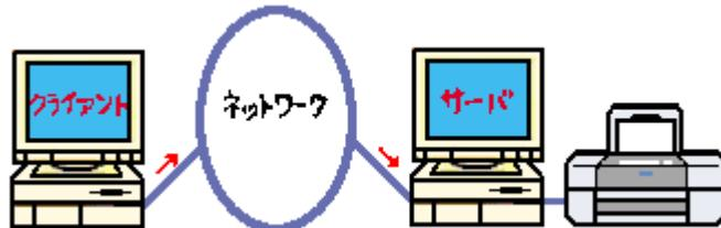
ネットワーク環境下において、本プリンタをネットワークプリンタ（共有プリンタ）としてお使いいただくことができます。イラストで示したように、インターフェイスカードやネットワークサーバを使用することなくプリンタをネットワーク上で共有する接続形態を「ピアトゥピア接続」と呼びます。プリンタを直接接続し、ほかのユーザーに共有させるコンピュータをプリントサーバと呼び、そのプリンタを利用するユーザーをクライアントと呼びます。詳しくは以下のページをご覧ください。
