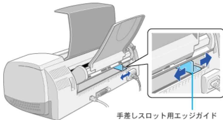
6. 印刷面を上にして、手差しスロット左側に用紙を沿わせて、用紙先端が内部ローラから 1cm 程度出るようにまっすぐ差し込みます。
