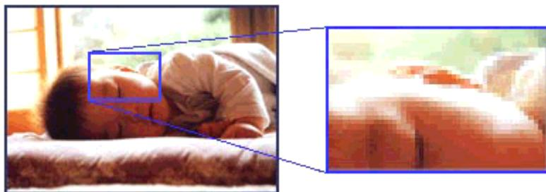
例えば、本プリンタの特長の一つである 2880dpi 印刷とは、25.4mm (1インチ) の長さ当りに 2880 個のインクの点を並べて打つことにより画像を構成していることを意味します。
