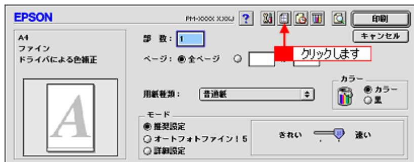
3. [割り付け印刷] をチェックして、[ポスター印刷] をクリックし、何分割で印刷するかを設定します。
