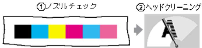
**ノズルチェック** : 上図のパターンを印刷する機能で、そのパターンを見て、ノズルが目詰まりしていないかを確認します。
