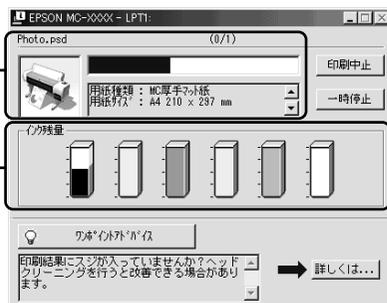
また、プリンタの操作パネルを操作してパネル設定モードに入り、[プリンタステータス] メニューで印刷可能枚数やインク残量などの情報を確かめることができます。
