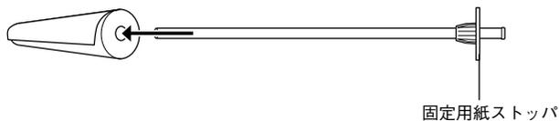
② 固定用紙ストップの右端にロール紙の芯が突き当たるまで押し込みます。
