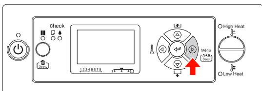
3 △/▽ ボタンを押し、[テスト印刷] を表示して、▷ ボタンを押します。
