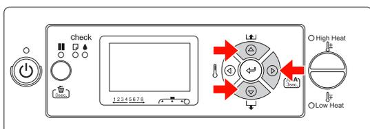
5 ◀ ボタンを押して、ノズルチェックパターンの印刷を開始します。
