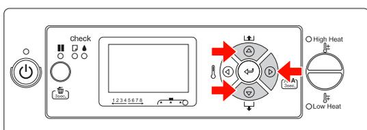
4 △/▽ ボタンを押し、[ノズルチェック] を表示して、▷ ボタンを押します。
