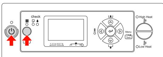
操作パネルにメンテナンスモードの最初のメニューが表示されます。
