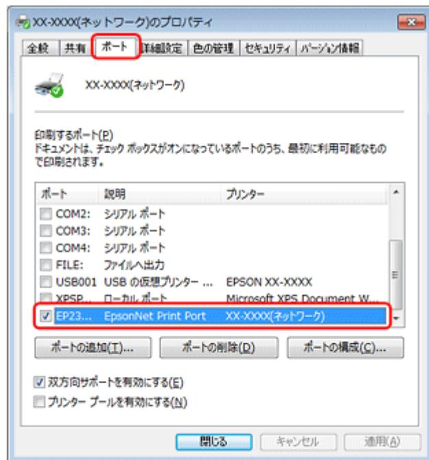
プリンターに付属のソフトウェアディスクでネットワーク接続設定をすると、印刷先は自動的に [EpsonNet Print Port] に設定されます。印刷先を標準 TCP/IP ポートに変更すると、DHCP 環境でプリンターの IP アドレスが変わったときに、変更後の IP アドレスを追従できなくなるため、接続できなくなります。DHCP 環境でご使用のときは、プリンターの印刷先を [EpsonNet Print Port] のままにすることをお勧めします。
