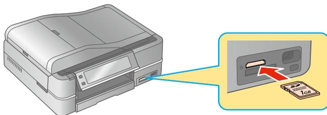
右ページの図を参照して、メモ리카ードを1枚だけセットします。
