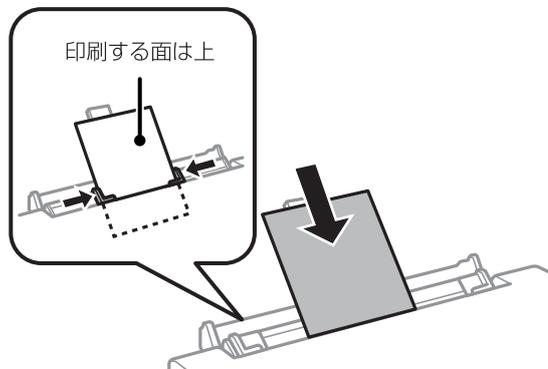
用紙の先端から約 5cm の部分を用紙ガイドのスリットに合わせてください。
