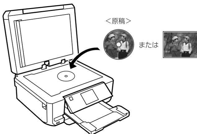
操作パネルで、[コピー] - [メニュー] - [ディスクレーベルにコピー] の順に選択し、画面の説明に従って操作してください。
