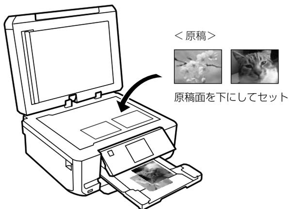
操作パネルで、[コピー] - [メニュー] - [写真コピー] の順に選択し、画面の説明に従って操作してください。
