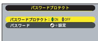
**3** パスワードを設定するには「パスワード」を選択し、リモコンの[Enter]ボタン、または本体の[自動調整/決定]ボタンを押します。
