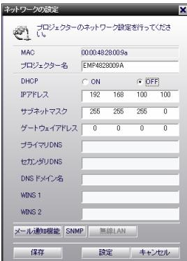
[DHCP]を[OFF]に設定しているときは、環境設定メニューの「高度な設定2」「ネットワーク」での設定内容が表示されます。変更があれば変更します。
