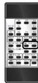
印刷物などの資料を提示するための資料照明とスライドフィルムやネガフィルムなどの透過資料を提示するためのベース照明が装備されています。フロント操作パネルの【ランプ】ボタンまたはリモコンのランプボタン（【資料】(LAMP・UPPER)、【ベース】(LAMP・BASE))を押すと、1～3秒して蛍光ランプが点灯します。
