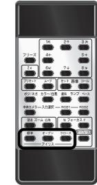
レンズの絞りを調整して映像の明るさを調整します。
