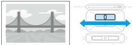
**2** スクリーンと画面の大きさが合わないときはズームリングで調整します。
