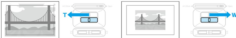
**3** ヨコ方向の台形ゆがみがあるときは、ヨコ補正スライダーを左右に移動させます。
