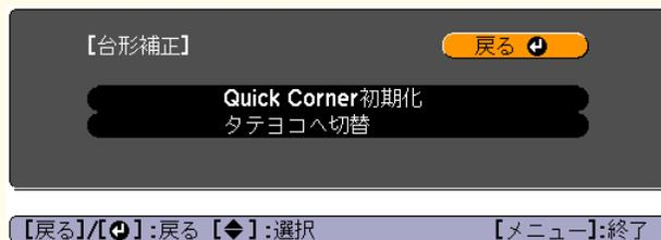
【Quick Corner初期化】：Quick Cornerで補正した結果を初期化します。
