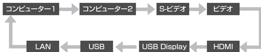
複数の機器を接続しているときは、目的の映像が投写されるまで【入力検出】ボタンを繰り返し押します。
