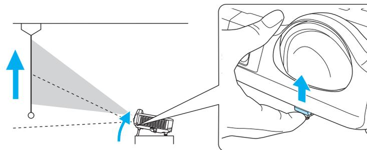
● 傾斜角度が大きくなると、ピントが合いにくくなります。傾斜角度が小さくなるように設置してください。
