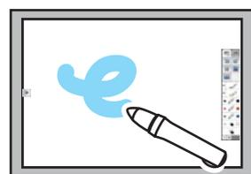
スクリーンから離して動かすことで、ポインタを移動します。これをホバリングと呼びます。
