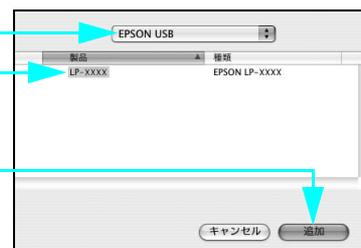
使用可能なプリンタがない場合は追加を促すダイアログが表示されます。[追加] をクリックすると上の画面が表示されます。なお、AppleTalk 接続の場合は、必要に応じて AppleTalk Zone も選択してください。
