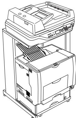
本機に用紙・トナーカートリッジ・感光体ユニットなどをセットし、使用可能な状態にセットアップします。
