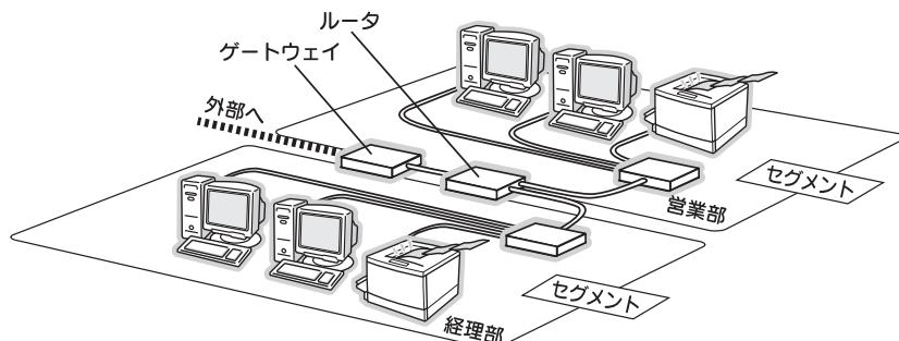
エリアを示す仕組みに利用されるのが、サブネットマスクです。サブネットマスクは、IP アドレスと同様、数字の羅列（例：255.255.255.0）で表されます。
