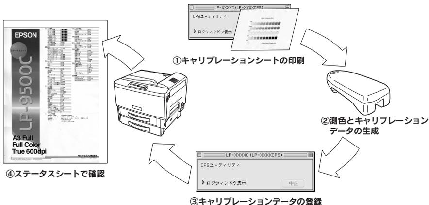
キャリブレーションデータを生成、登録することにより、同じプリンタを複数台使用している場合、色の個体差を補正し、複数のプリンタで近似した色合いの印刷が可能になります。
