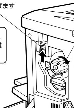
ノブを矢印の方向に止まるまで回します。ノブが止まると、装着口の右側のETカートリッジが装着口の位置に来ます。
