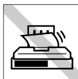
使用中に、定着ユニットを引き出したときは定着器部分に触れないでください。
