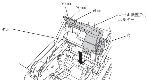
8. ネジ（3×6）を締めて、ロール紙壁掛けホルダーをベースフレームに固定します。
