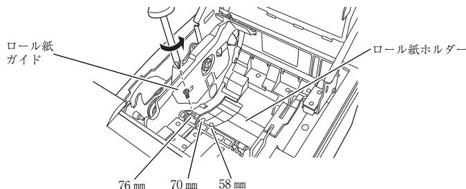
7. ロール紙壁掛けホルダーの穴と、ロール紙ガイドのダボを合わせてセットします。（紙幅を変更する場合は、使用する紙幅によってロール紙壁掛けホルダーの穴が異なります。）
