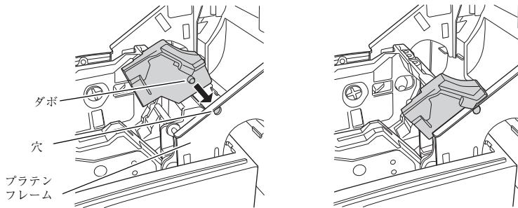
12. カムをプラテンフレームの側面に沿って、「カチッ」と音がするまで矢印方向に回します。この時、ブレーキアームのピンが、カムの内側の溝に入っていることを確認します。
