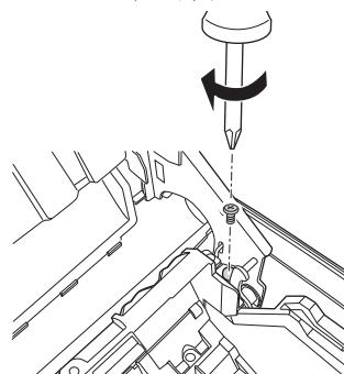
9. ネジ（3×10）を締めて、ロール紙壁掛けホルダーをロール紙ホルダーに固定します。
