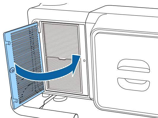
9 エアフィルターカバー固定ネジを取り付けます。
