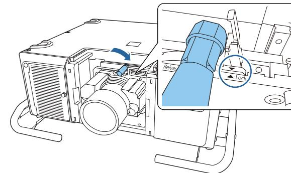
より確実にレバーを固定するには、ネジを締めて固定します。ネジは手で回せます。
