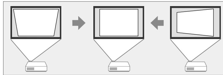
台形補正/上下ボタンで映像を補正できる条件は、投写角度が上下左右約30°のときです。
