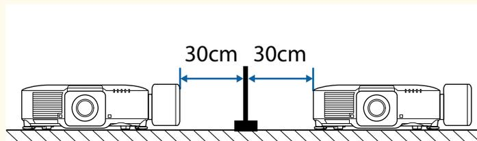
プロジェクターの周囲に十分なスペースがなく、プロジェクターの内部温度が上昇すると、光源の明るさが低下することがあります。
