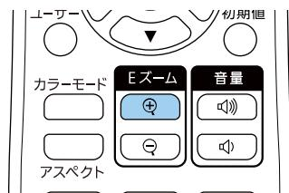
映像の中央を中心にして、拡大表示されます。1~4倍まで、25段階で拡大できます。
