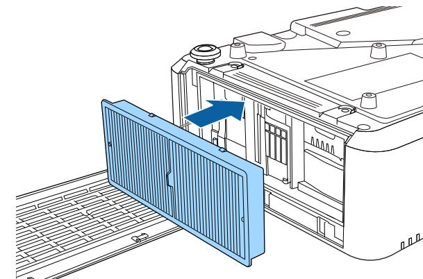
**9** エアフィルターカバーを閉めて、固定ネジを締めます。
