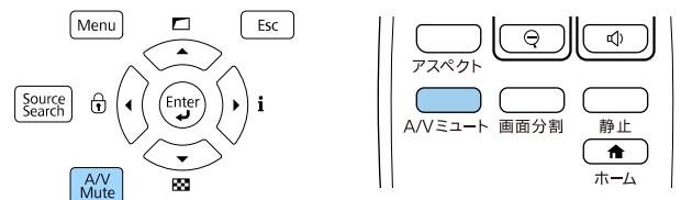
光源が消灯して、映像と音声が遮断されます。
