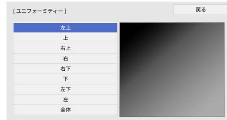
最初に画面の周囲を調整します。最後に [全体] を選択し、画面全体を調整します。
