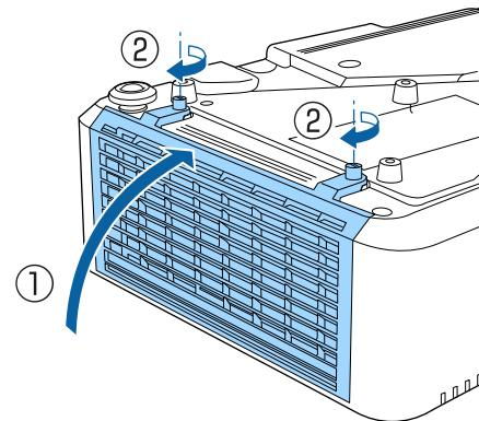
**3** 固定ネジをゆるめて、エアフィルターカバーを開けます。
