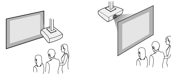
設置する場所や方法に合わせて、[設置] メニューで [設置モード] を選択します。必要に応じて、[動作] メニューの [方向ボタン反転] と [表示] メニューの [メニュー回転] の設定を変更してください。
