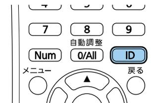
プロジェクターに設定されたIDが投写画面に表示されます。表示は約3秒後に消えます。
