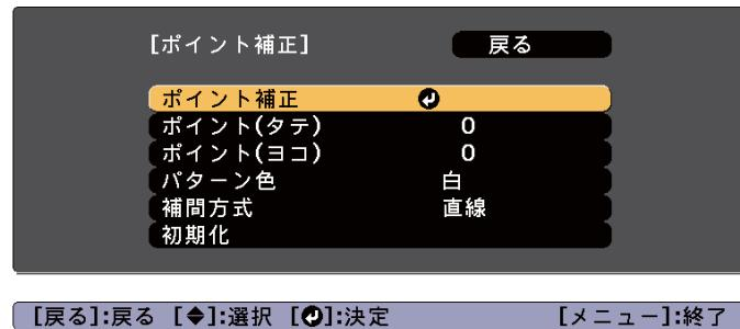
6 [▲][▼][◀][▶]ボタンでガイドを補正したいポイントに合わせ、[↔]ボタンを押します。
