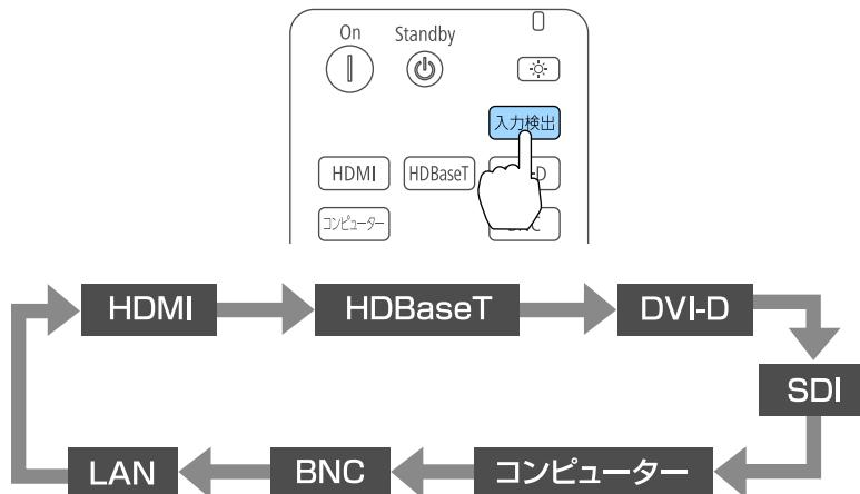
複数の機器を接続しているときは、目的の映像が投写されるまで【入力検出】ボタンを繰り返し押します。
