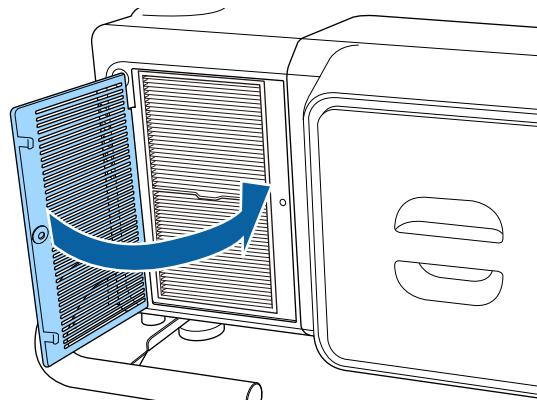
7 エアフィルターカバー固定ネジを取り付けます。
