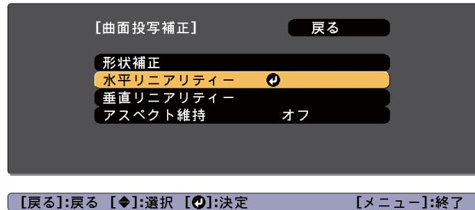
左右方向の伸縮を補正する場合は【水平リニアリティ】、上下方向の伸縮を補正する場合は、【垂直リニアリティ】を選択します。
