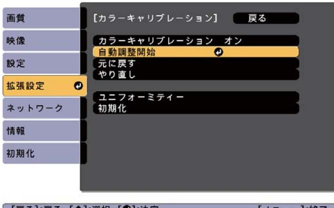
調整パターンが表示され、補正が開始されます。補正前の投写映像が表示されたら終了です。
