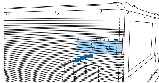
5 USB-A端子用カバーをネジで固定します。
