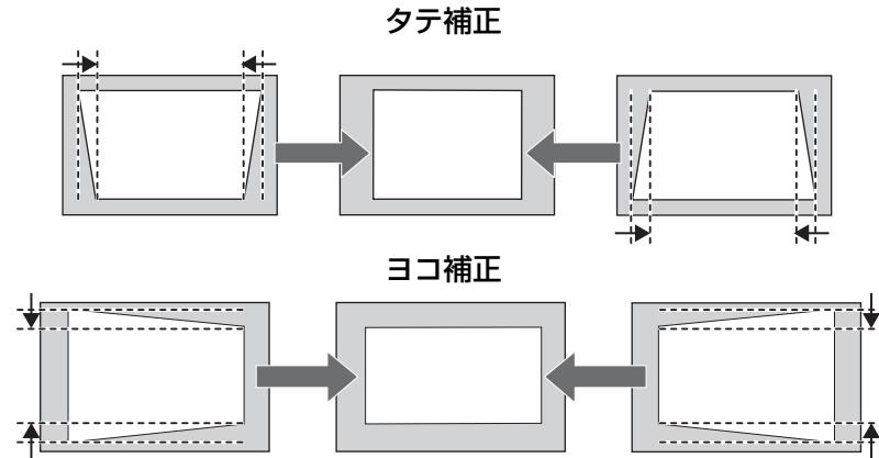
映像のアスペクトが崩れたときは、[タテバランス]と[ヨコバランス]で映像のバランスを調整します。
