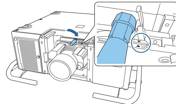
より確実にレバーを固定するには、ネジを締めて固定します。ネジは手で回せます。
