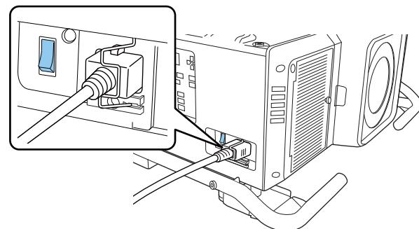
本機の電源インジケーターが青色に点灯します（スタンバイ状態）。スタンバイ状態は、プロジェクターに電力が供給されていて、電源が入っていない状態です。
