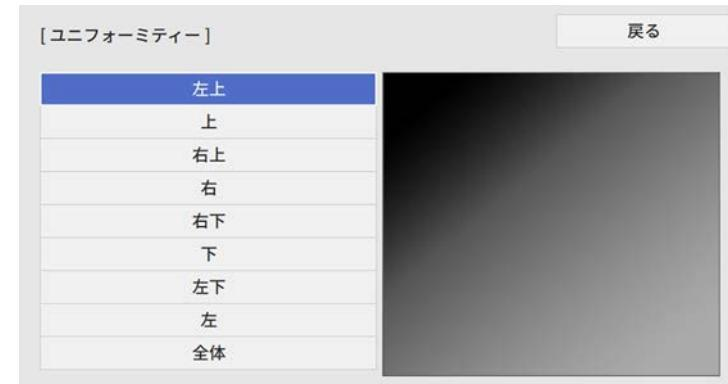
最初に画面の周囲を調整します。最後に [全体] を選択して、画面全体を調整します。
