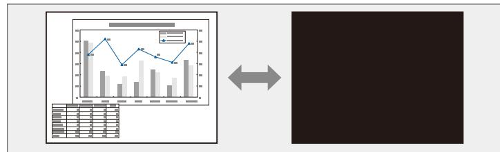
**1** リモコンの【A/Vミュート】ボタンを押して、映像と音声を一時的に遮断します。
