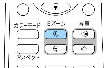
映像の中央を中心にして、拡大表示されます。1~4倍まで、25段階で拡大できます。
