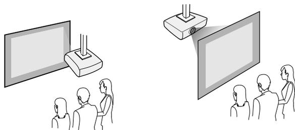
設置する場所や方法に合わせて、[設置]メニューで[設置モード]を選択します。必要に応じて、[表示]メニューの[メニュー回転]を調整します。
