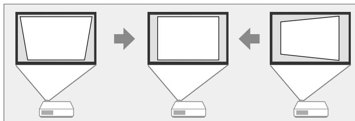
台形補正/上下ボタンで映像を補正できる条件は、投写角度が上下左右約15°以内のときです。
