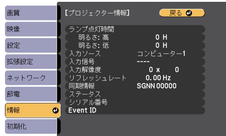
現在投写している入力ソースによって設定できる項目が異なります。ランプ点灯時間は、ランプを10時間以上使用するまで加算されません。
