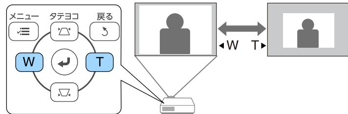
デジタルピクチャーシフト機能を使って、本機を動かさずに映像の投写位置を微調整できます。
