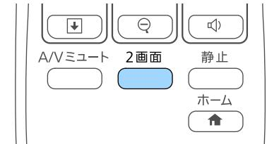
投写している入力ソースの映像が左画面に投写されます。
