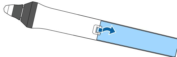
**2** 電池の+と-の向きを確認してリモコンにセットします。
