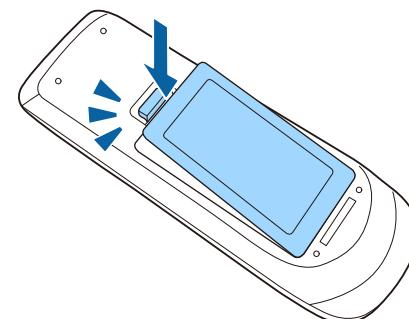
インタラクティブペンの交換用電池は、単3形マンガン乾電池、単3形アルカリ乾電池、またはeneloop（BK-3MCC）充電池を用意してください。電池がなくなったら電池を交換してください。
