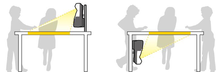
設置する場所や方法に合わせて、[拡張設定] メニューで [設置モード] を選択します。
