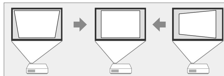
台形補正/上下ボタンで映像を補正できる条件は、投写角度が上下左右約3°のときです。
