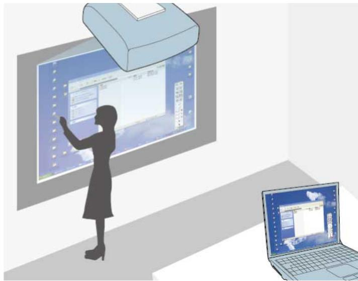
本機とコンピューターをUSBケーブルで接続すると、インタラクティブペンまたは指（EB-695WT）を使って、投写画面上でコンピューターを操作できます。コンピューターのマウスと同じように、クリックやドラッグ＆ドロップなどができます。
