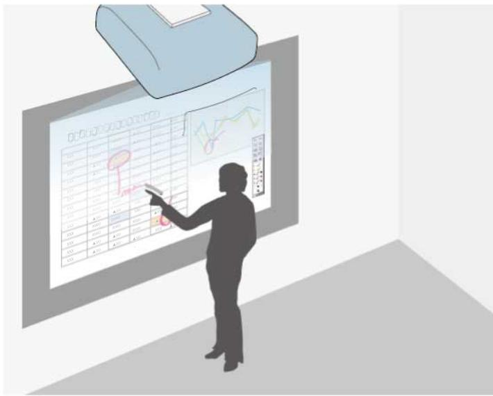
アノテーションモードでは、コンピューター、タブレット端末、ビデオ機器などから投写した資料に、ペンまたは指（EB-695WT）を使って注釈を書き込みます。
