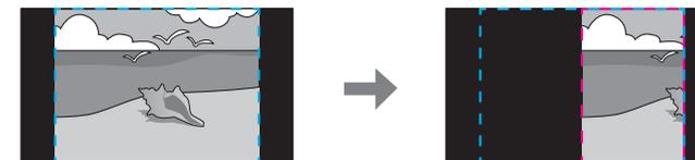
[フル表示]：プロジェクターのパネルサイズ(映像を表示できる最大領域)を基準にして調整します。
